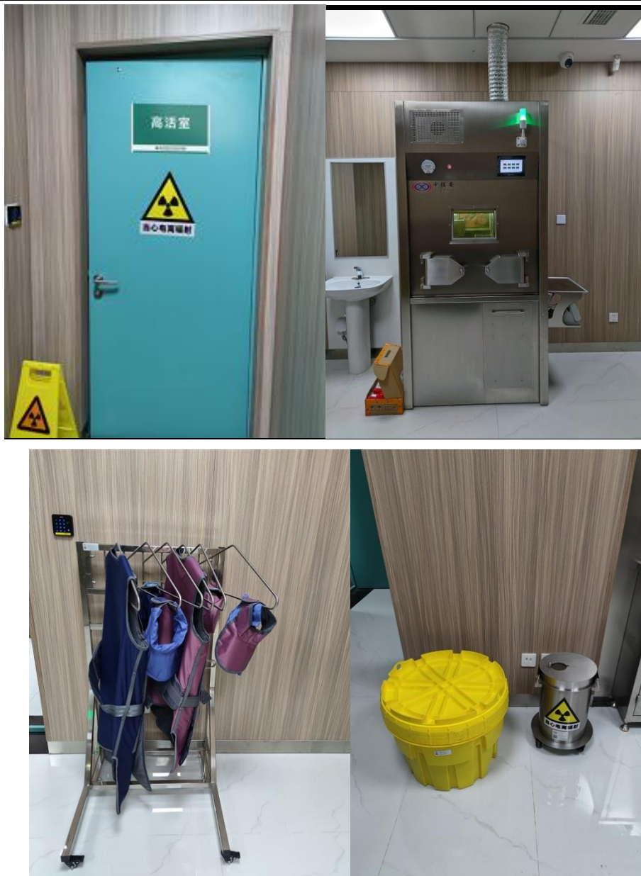
高活室设有电离辐射标识，配备了一个 50mmPb 当量的手套箱并带有活性炭过滤器，配备 2 套铅衣铅围脖、2 个铅废物桶（10mmPb、20mmPb）、1 个应急去污箱
